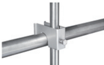
70019 ☒ 100 Rohrhalter verbindet 1/2" Wasserrohr mit 3/4" bis 1" Stahlrohr, inkl. Schraube M8 x 25 mm Pipe holder connects 1/2" water pipe with 3/4" to 1" metal pipe, incl. screw M8 x 25 mm
