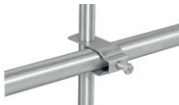
70019-2 ☒ 50 Rohrhalter verbindet 1/2" Wasserrohr mit 3/4" bis 1" Stahlrohr, inkl. Schraube M8 x 25 mm Pipe holder connects 1/2" water pipe with 3/4" to 1" metal pipe, incl. screw M8 x 25 mm
