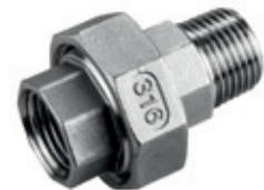
1196-13 Verschraubung 1/2" - 1/2", IG/AG mit Überwurfmutter für einfachere Montage, selbstdichtend Screw connector 1/2" - 1/2", female/ male with turning nut for easier instal- lation, self sealing
